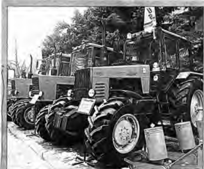
Новая разработка Минского тракторного завода – трактор для садов и виноградников MT3-921.
